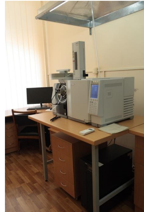
Хроматомас-спектрометр Shimadzu GCMS-QP2000
