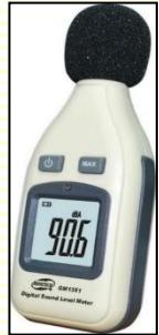
Шумомір GM1351 призначений для вимірювання рівня звукового тиску в децибелах (dB).
