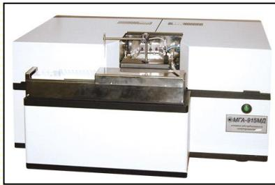
Атомно-абсорбційний спектрометр МРА-915МД призначений для визначення вмісту хімічних елементів у воді, ґрунті, донних відкладах, атмосферному повітрі, а також тканинах рослинного і тваринного походження. За його допомогою проводять експрес-аналіз і безперервний контроль складу речовин в технологічних процесах, а також вхідний контроль та контроль готової продукції.
