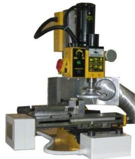
**Станок для шліфування торців керну «Шторм»**
