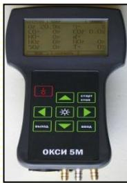
Газоаналізатор ОКСІ 5М призначений для еколого-теплотехнічних вимірювань об'ємної частки кисню O<sub>2</sub>, окису вуглецю CO, оксиду азоту NO, діоксиду азоту NO<sub>2</sub>, діоксиду сірки SO<sub>2</sub>, тиску в газоході і температури в димових газах при обслуговуванні газового обладнання.
