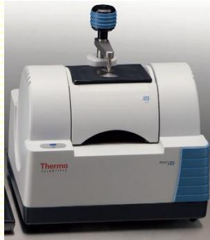
**Инфракрасный спектрометр с Фурье-преобразованием Thermo Scientific Nicolet iS5:** получение инфракрасных спектров соединений, качественный (классификационный) и количественный анализ жидких, твердых и газообразных образцов, включая газ, нефть и нефтепродукты.
