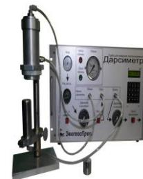
**Прилад для визначення проникності зразків керну по газу «Дарсіметр»**
