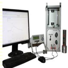
**Прилад для вимірювання електричних властивостей гірських порід «Петроом»**
