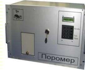
**Газоволюметричний пікнометр «Поромір»**
